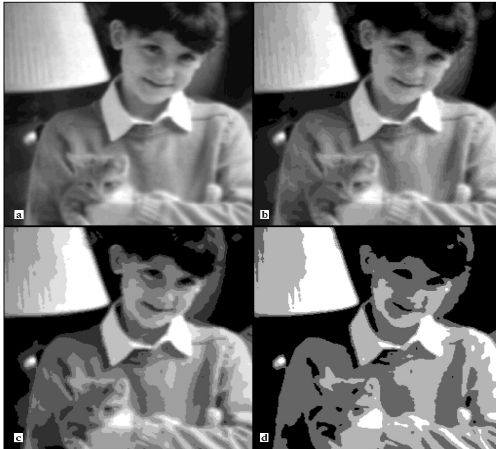
Image 256x256 array pixels: (a) 32 bit (b) 16 (c) 8 (d) 4
